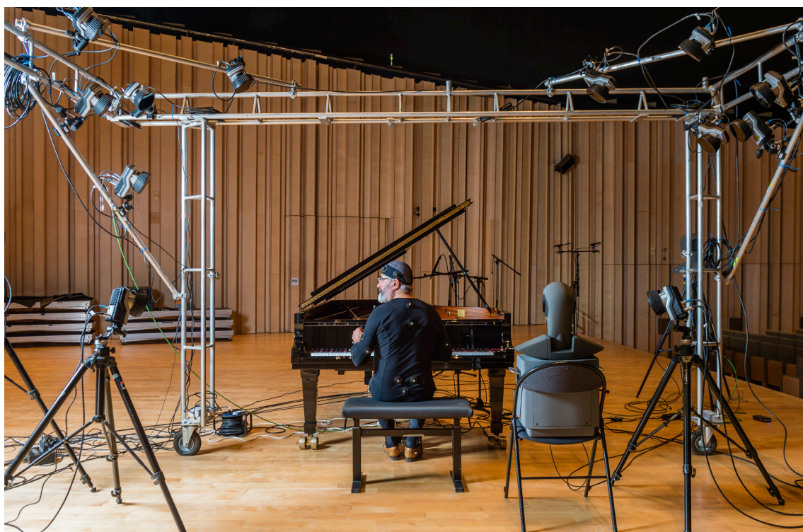
Figure 3 : Vue d'ensemble du dispositif expérimental avec la structure métallique supportant le système de capture de mouvement composé de 15 caméras, les têtes artificielles et les couples de microphones. Photo : Cyril FRESILLON / Pprime / CNRS Photothèque.
